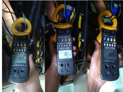
**Gambar 9. Hasil Pengukuran Arus Sebelum Dipasangkan Beban**
