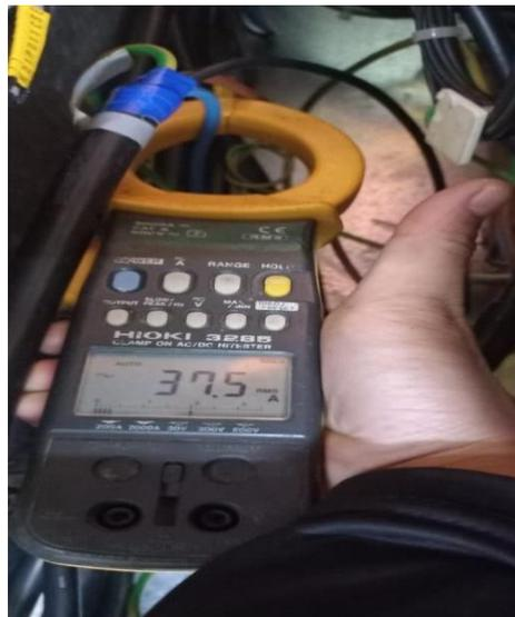
**Gambar 10. Hasil Pengukuran Arus Setelah Dipasangkan Beban**
