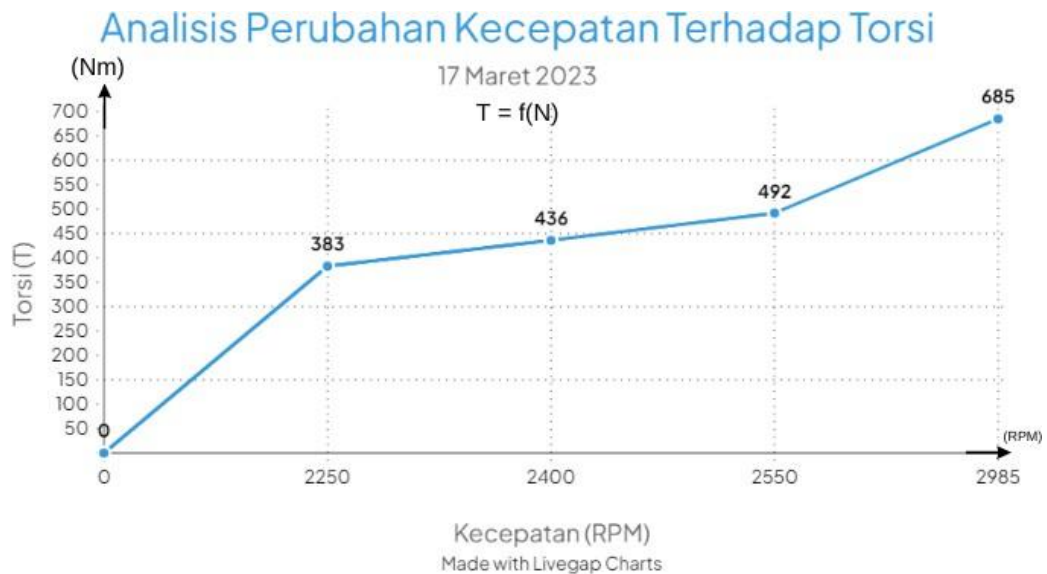
Gambar 14. Analisis Pengaruh Frekuensi Terhadap Torsi
