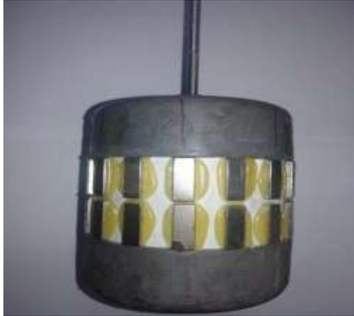
**Gambar 4.** Peletakan Magnet.
