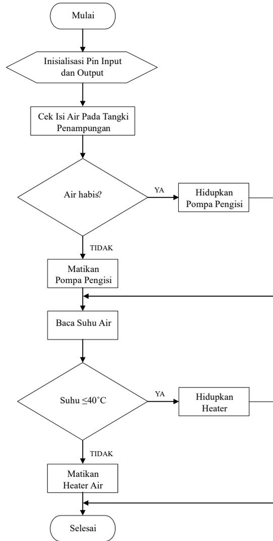
**Gambar 1.** Blok diagram sistem
