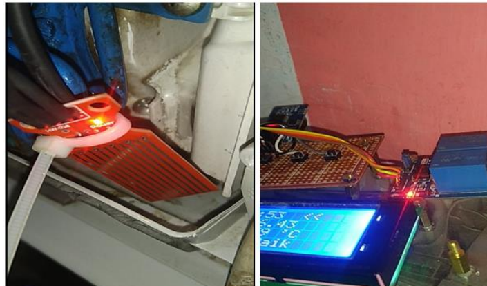
Gambar 9. Percobaan Sensor Water Level Dan Relay Pada Kondisi Kering
