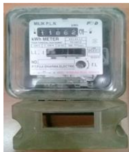
Gambar 1. Kwh Meter satu Fasa Sumber: Gunawan D, 2018
