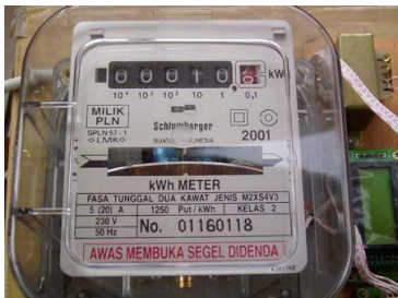
Gambar 3. KWH Meter Analog Sumber: Gunawan D, 2018
