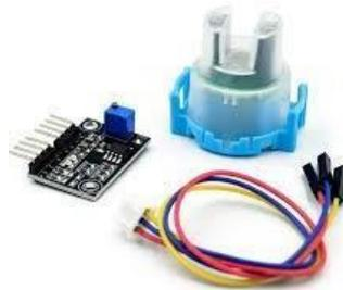
Gambar 5. Sensor Turbidity dan Modul Sensor
