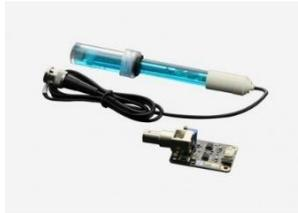
Gambar 3. PH Meter 4502C dan probe BNC
