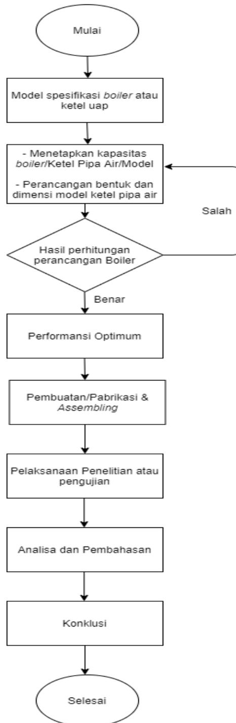
Gambar 1. Diagram Alir Perancangan dan Pembuatan Model Boiler
