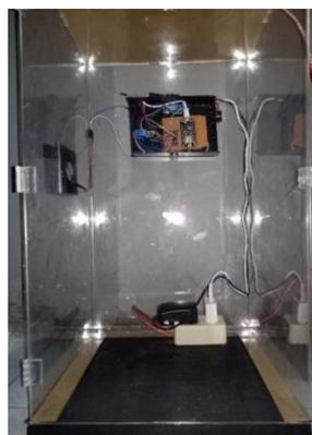
Gambar 6. Realisasi Sistem Pendeteksi Kebocoran Gas LPG Menggunakan Sensor MQ-2 Berbasis *NodeMCU ESP8266*
